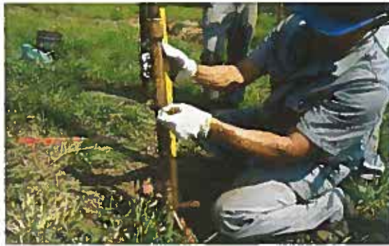
Cap. 3: Sondagem a percussão: abertura do amostrador SPT.
