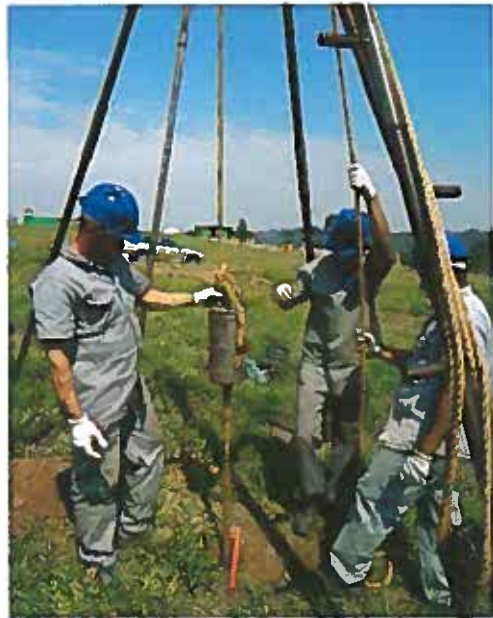
Cap. 3: Sondagem a percussão: ensaio SPT – cravação manual.
