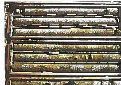
Cap. 5: Amostragem de granito alterado obtido por técnicas de alta qualidade com 86 mm de diâmetro e com injeção de bolhas (air bubble).
