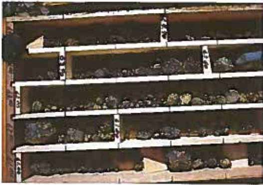
Cap. 5: Amostra de brecha vulcânica obtida por sondador sem experiência.
