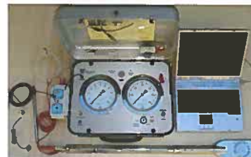
Cap. 11: Ensaio especial em solo: equipamento para ensaio SDMT Marchetti.
