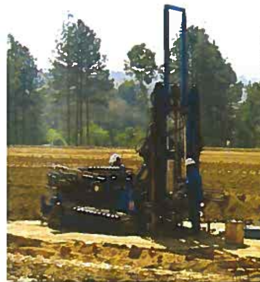
Cap. 11: Ensaio especial em solo: equipamento para ensaio CPTu.
