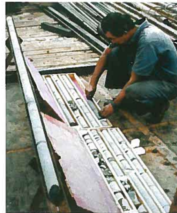
Cap. 5: Acondicionamento de testemunho de sondagem.
