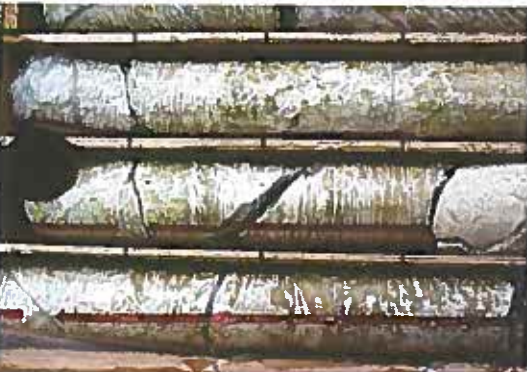
Cap. 5: Amostra de granito alterado obtido em barrilete triplo de 86 mm de diâmetro.
