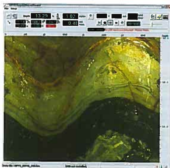
Cap. 10: Perfilagem óptica: imagem na tela do computador.
