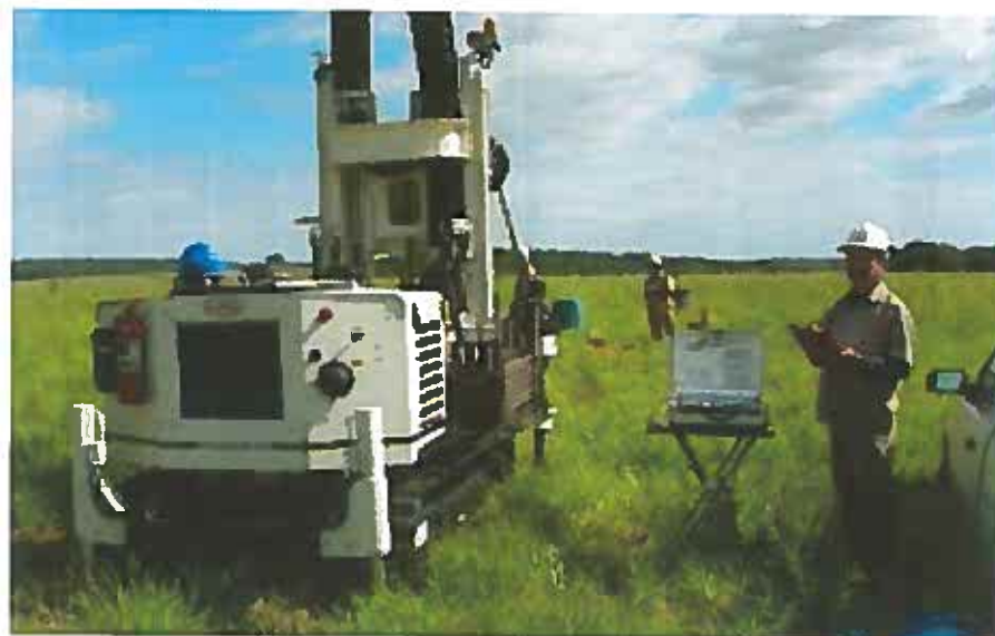
Cap. 11: Equipamento para ensaio DMT (Fonte: Site da empresa Damasco Penna Engenharia Geotécnica).
